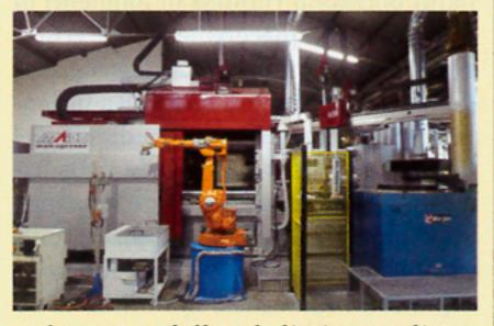
Dal 1986 Fondall S.r.l. di Cimetta di Codognè è specializzata nella pressofusione delle leghe d'alluminio. Il reparto produttivo si avvale di 6 presse di stampaggio, nella gamma da 250 a 750 tonnellate. Le isole di pressofusione sono completamente automatizzate e asservite da robot di scarico pezzi. Su tutti i pezzi stampati vengono inoltre eseguite le operazioni di tranciatura, sbavatura, levigatura, burattatura, sabbiatura, foratura e filettatura.
