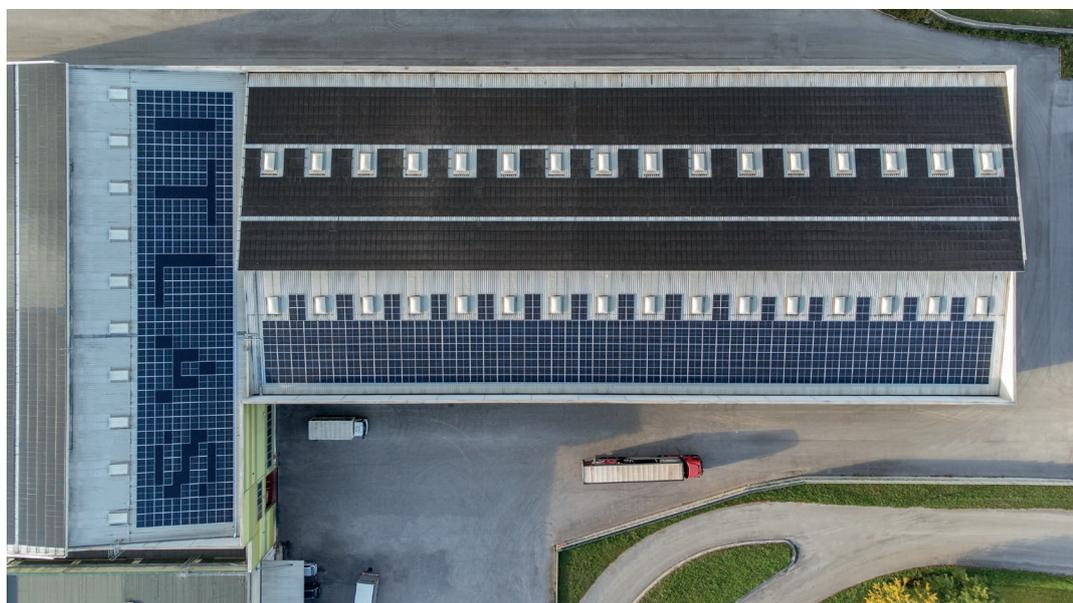
Gran parte del contributo della produzione di energia del nuovo impianto fotovoltaico viene utilizzata per autoconsumo. Considerando quindi anche l'attuale dotazione di impianti fotovoltaici, nel 2021 il 20 per cento dell'energia elettrica annuale consumata da ITLAS è prodotta internamente da fonte rinnovabile.
